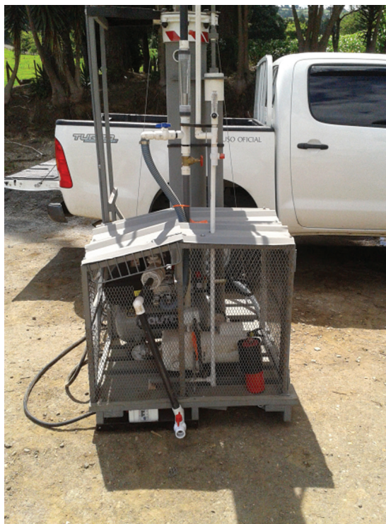
Figura 2 La unidad de purificación construida es portátil.
