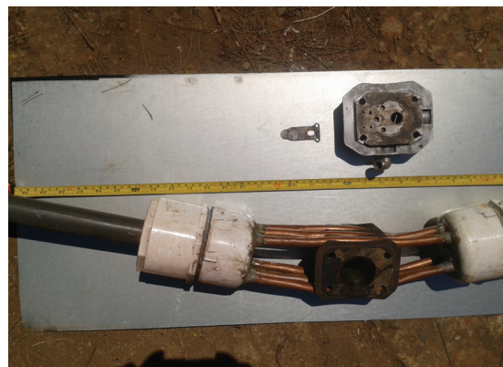
Figura 5 Cabeza del compresor de aire modificada con tubos de cobre por donde pasa agua para enfriarla.
